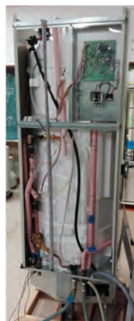
図2 温度成層型蓄熱タンク
