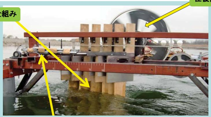
チェーンの一箇所(下図中央付近の $\leftrightarrow$ )を左右に移動させると2つの歯車を一定方向に回転させることができる。
