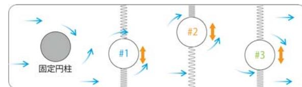
固定された円柱の風下にバネ支持された円柱を、等間隔に3本直列に並べて風洞実験を実施し、3本とも大振幅の発散的な振動をすることを見出した。
