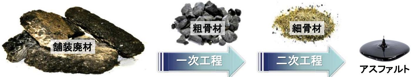
この技術は主に熱水中での攪拌によって**舗装廃材を解碎・分級し、粗骨材(石)を再資源化する一次工程**と、**細骨材(砂)とアスファルトを分別、回収する二次工程**からなります。
