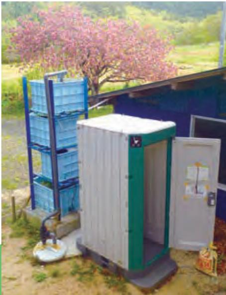
写真1:自立型トイレの試験機1号
