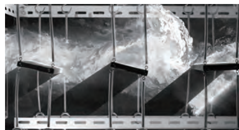
図2 振動する平板まわりの風の可視化
